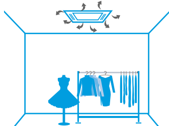
Rozkład powietrza z zabrudzonym filtrem
