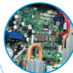
Nowy 7-segmentowy wyświetlacz do sprawdzania błędów i ustawień systemów
